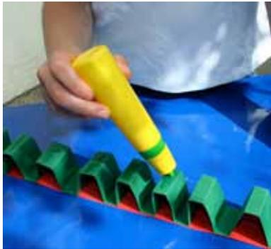
Abb. 38: Das Fachwerk vor dem Austesten gut trocknen lassen, sonst leidet die Stabilität!
