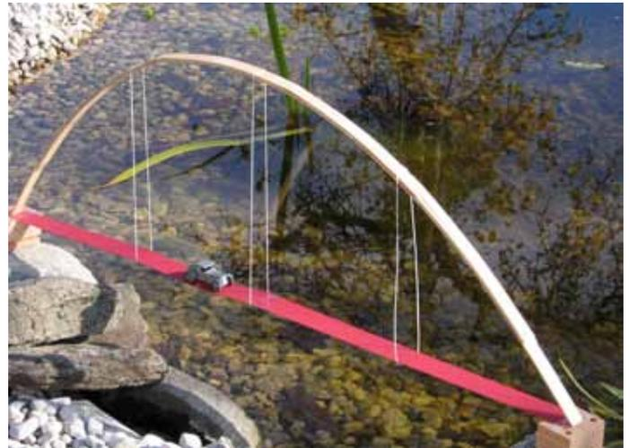
Abb. 30: Die Fahrbahn hängt an der weißen Schnur und ist zusammen mit dem Holzbogen mit Klebstreifen an den Widerlagerblöcken befestigt.
