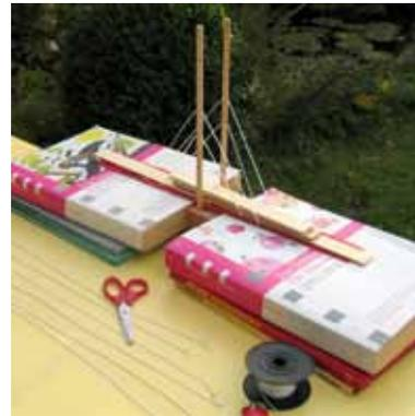
Abb. 33: Das Tonpapier wird alle 3 Zentimeter von einem Schrägseil gehalten. Damit die Fahrbahn eben wird, liegen ein paar Brettchen aus dem Experimentierkasten als Gewicht darauf.
