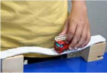
Abb. 40: Die Drähte im Inneren machen die Brücke trotz Durchbruch des Tons noch passierbar.
