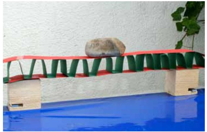
Abb. 39: Belastungstest für die einfache Fachwerkbrücke
